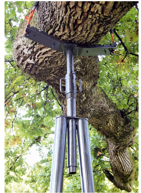
A-Stütze im Detail mit Gewinde zum Nachstellen und Spanngurtbefestigung
