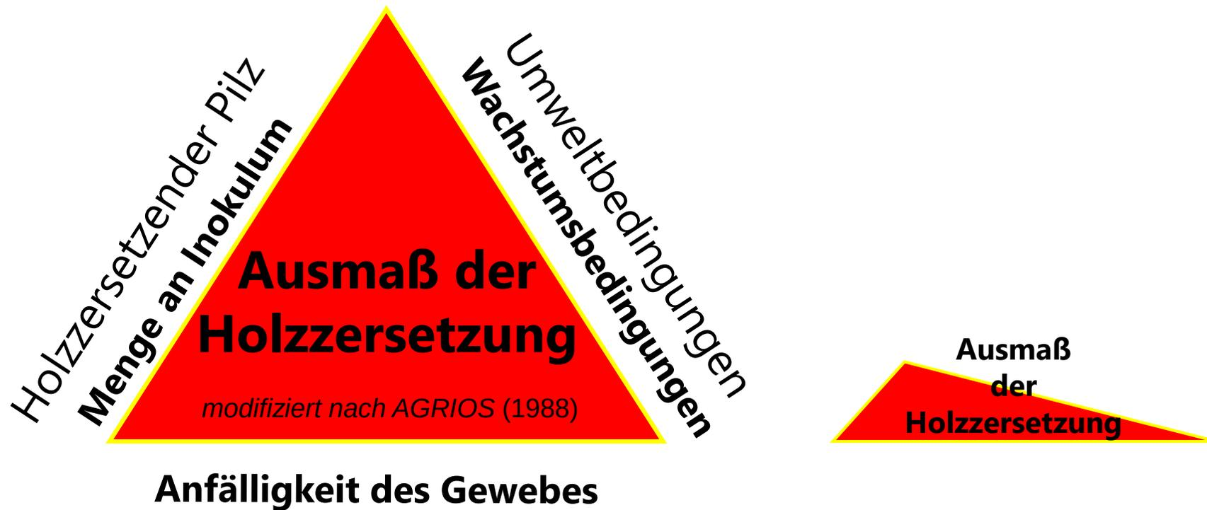
Die Länge der drei Seiten symbolisiert die Qualität der am Entstehen einer Holzzersetzung beteiligten Faktoren. Die Fläche des Dreiecks symbolisiert das Ausmaß der Holzzersetzung.
