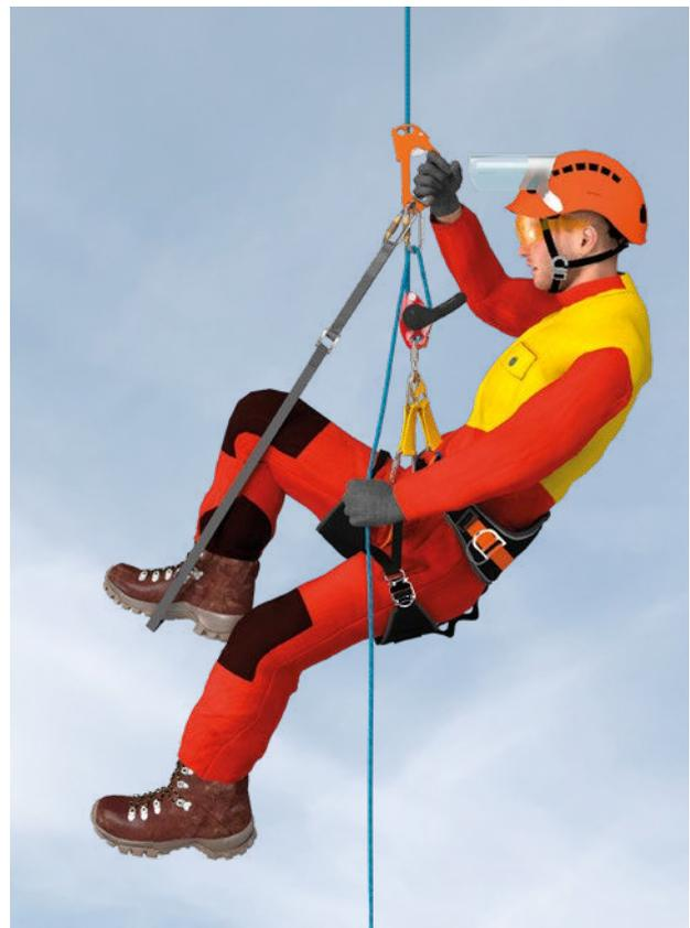
Einfachseilabstieg mittels Sicherungsgerät und Steigklemmen
