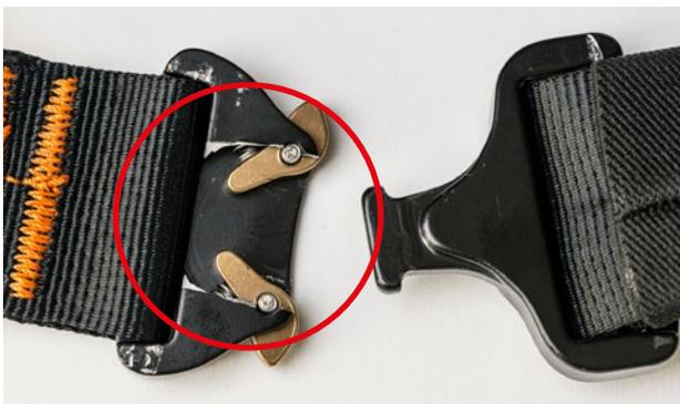
Verschlusswirkung der Steckschnalle aufgrund mechanischer Beschädigung nicht mehr voll funktionsfähig.
