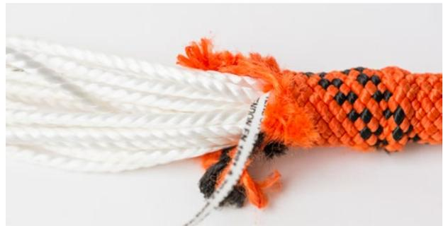
Beschädigung des Mantelgewebes bei einem Kern-Mantel-Seil aufgrund mechanischer Einwirkung.
